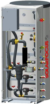
Der hydrotower easy ist ein Doppelspeicher mit 255-Liter-Trinkwasser- und 255-Liter-Puffer-volumen mit integriertem Hydraulikmodul. Der emaillierte Systemspeicher mit Hydraulikeinheit bildet zusammen mit der Wärmepumpe **vamp<sup>air</sup> PRO** ein kompaktes Heiz- und Kühlsystem für Flächenheizungen.
